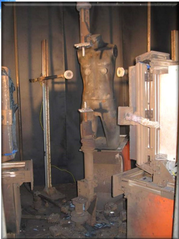
Манекен с сенсорами и температурными датчиками
