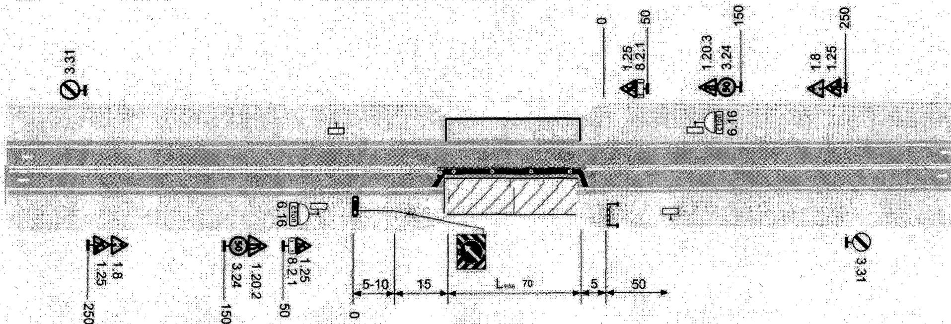
Рабочая зона производства долговременных работ на полосах движения и тротуарах моста (путепровода). Пропуск транспортных средств встречных направлений осуществляется с помощью светофорного регулирования. В ночное время по периметру зоны работ горят фонари красного света и светодиодный комплекс знака 4.2.2.
