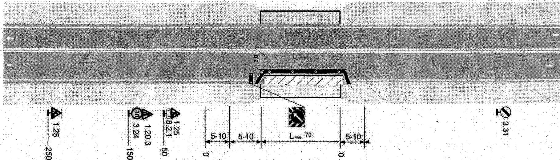
Рабочая зона производства краткосрочных работ на полосах движения и тротуарах моста (путепровода).
